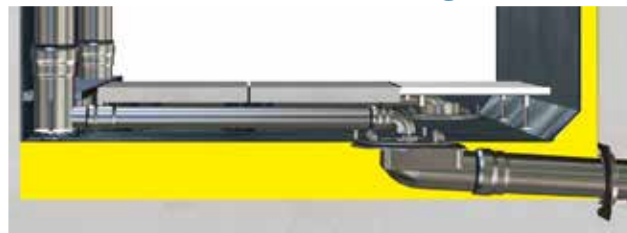
Kaskade-Sammelleitung unter dem Terrassenbelag
